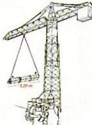
La grúa levanta las cargas mediante dos alambres de acero atados a los extremos de la carga cuya longitud es de 3,20 m.
